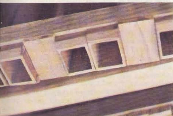
Fig. 64: Parte superior de las cajas de resonancia de madera.
