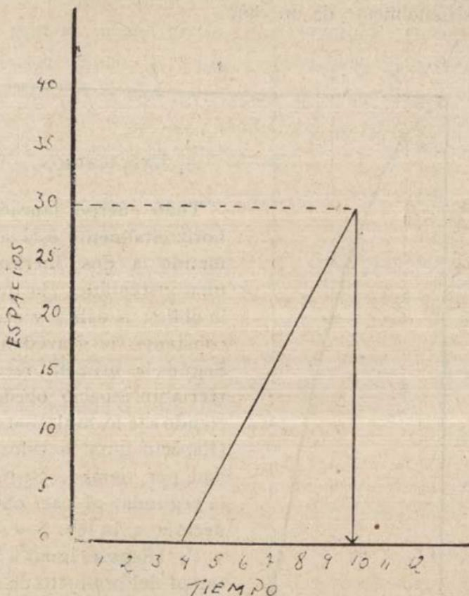
Como en los casos anteriores, trazaremos una diagonal que partiendo del 4, (eje tiempo) pase por los puntos 5-5; 10-6; 15-7; etc., hasta encontrar la altura del 30, (eje de espacios). La perpendicular del extremo de esta diagonal
