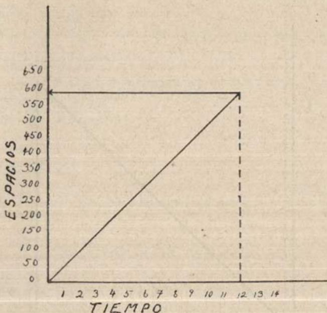
Explicación: Si en una hora recorre 50 km., en 2, 100, en 3, 150, etc. Pues bien, trazando la diagonal que pase por los puntos de intersección 1-50; 2-100, etc., hasta alcanzar la perpendicular correspondiente a las 12 horas y, trazando luego, desde su extremo la perpendicular al eje de espacios; obtendremos el número 600.
